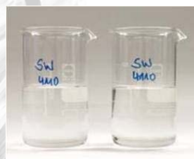
Zuivere paraffine was Beide afbeeldingen: links net geproduceerd, rechts drie weken later.
