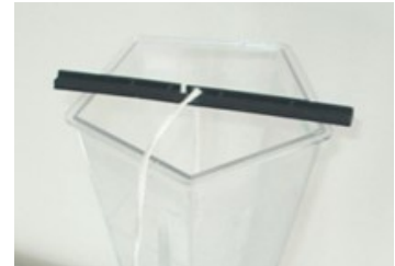
Pitslem: door de wigvormige inkeping zit de pit direct vast zonder te knopen.
